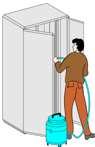
شکل ۶-۷۰- پاکسازی فضای داخل تابلو با استفاده از جاروبرقی
