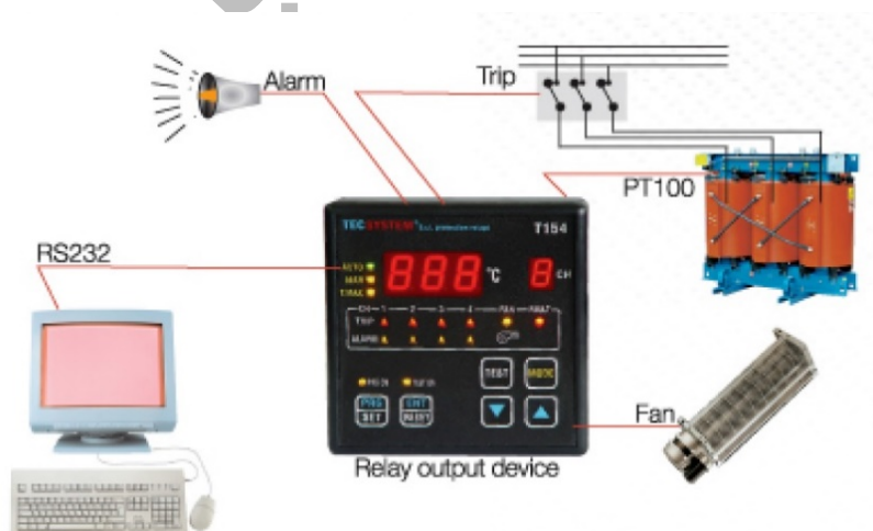
شکل ۸-۱۹- رله ترمومتر دیجیتال ترانسفورماتور خشک
