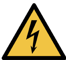
شکل ۶-۵۸- نماد خطر برق گرفتگی
