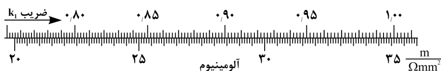
شکل ۶-۱۱- ضرایب اصلاحی رسانایی شینه‌های مسی و آلومینیومی
