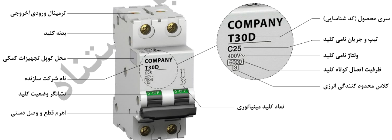
شکل ۶-۳۰- اجزای مختلف کلید مینیاتوری و مشخصات فنی آن
