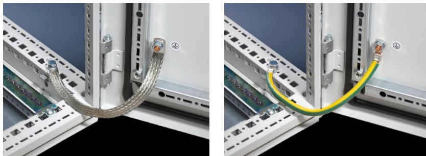
شکل ۶-۹- استفاده از سیم با روکش زرد-سبز یا تسمه مسی با روکش قلع برای هم‌بندی قطعات فلزی متحرک تابلو برق
