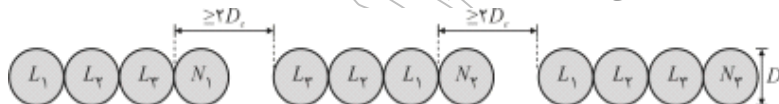
شکل - آرایش مخصوص همتراز برای 9 رشته کابل تک رشته موازی (سه فاز)
