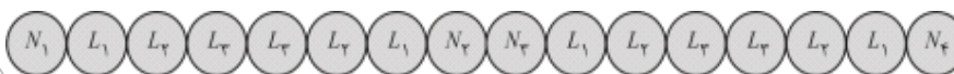
شکل - آرایش چسبیده به هم و همتراز برای 12 رشته کابل تک رشته موازی (سه فاز)
